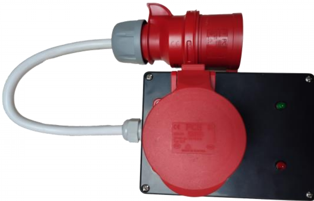
24. ábra A vezeték nélküli árammérő szenzor
