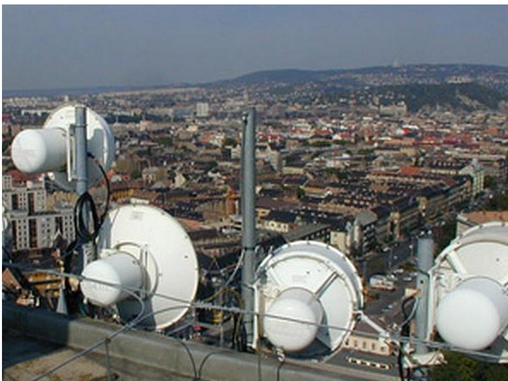
Pont-pont összeköttetést biztosító, antennával egybeépített kis (2.048 Mbit/s) és közepes (8.448 Mbit/s) kapacitású digitális mikrohullámú adóvevők az 1990-es évek elején.
