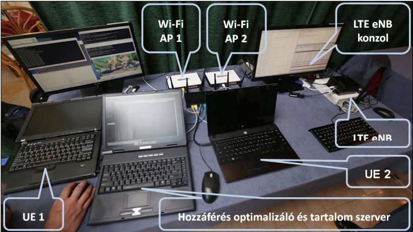
4. ábra A COMBO demonstrációs összeállítás fényképe
