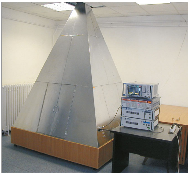
6. ábra Immunitás vizsgálatokra szolgáló GTEM cella
